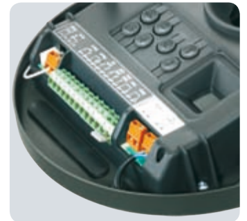
Connexion rapide de divers accessoires grâce au bornier débrochable
